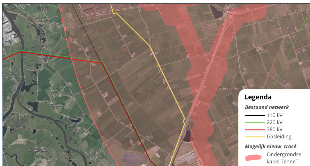
Afb. 2: Overzicht hoogspanningslijn, kabeltracé en gasleiding in het gebied
